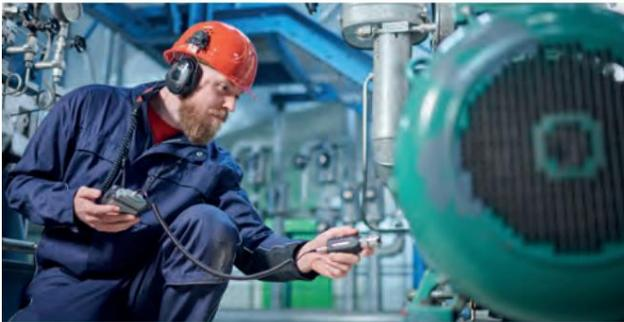
→ Detectar daños en los rodamientos a tiempo y optimizar la lubricación de los rodamientos
