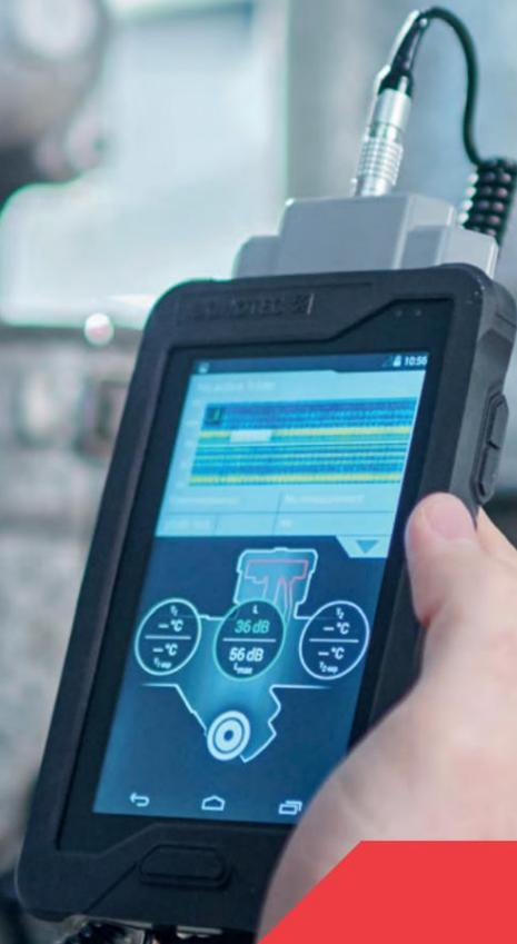
Dispositivo de prueba ultrasónico digital
